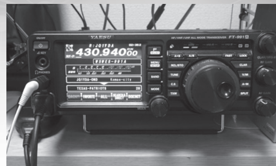
写真1 八重洲無線 FT-991Aで海外交信中の様子 WIRES-X公開ノード経由で、TEXAS-PATRIOTSルームで交信中の様子。アクセス中のノードはJQ1YDA(ID:JQ1YDA-OND) 交信相手局のコールサイン W5WESが表示されている
