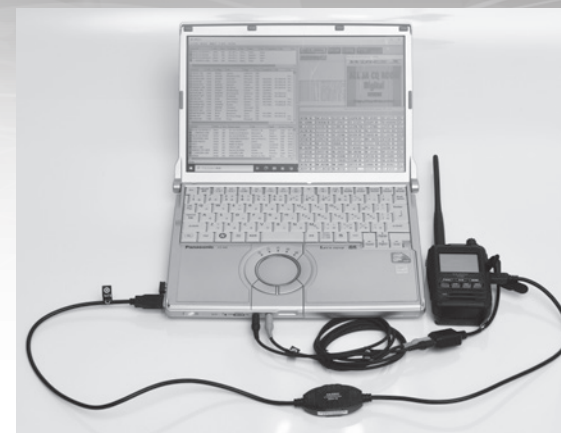
写真2 八重洲無線 FT5Dを使ったポータブル・デジタル・ノード(PDN)の例 海外交信を行う場合「ポータブルHRIモード・ダイレクト運用」がお勧め。オプションのケーブル(SCU-39)を用意して、説明書に沿ってケーブルを写真のようにつなぎ、音声レベルの調整もしっかり行う
